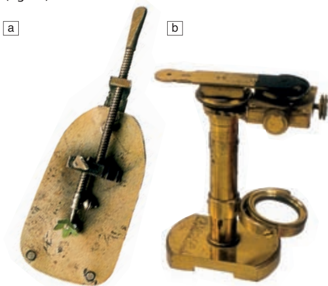
Fig. 1.1. Los primeros microscopios ópticos simples (de una sola lente). a) El fabricado por Leeuwenhoek en el siglo XVII. b) Pequeño microscopio óptico del siglo XIX que fue utilizado por Robert Brown. Mide 7,6 cm y entre los accesorios hay una lente de 800 aumentos.
